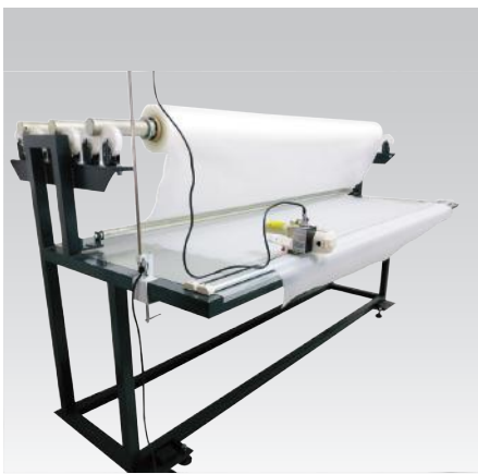
Portarrollos eléctrico con cortador guiado / Electrical EVA dispenser with guided cutter
